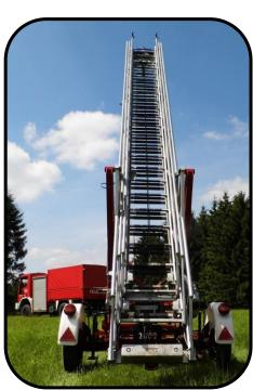
Anhängeleitern sind Feuerwehranhänger mit einem Leiteraufbau. Sie werden hauptsächlich von kleinen Freiwilligen Feuerwehren eingesetzt. Sie kann mit einem Fw-Fahrzeug, LKW oder Traktor sowie von Hand zur Einsatzstelle gezogen werden.
