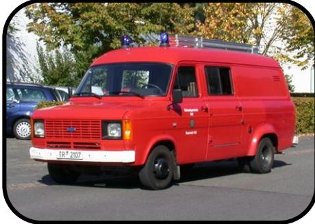
Das Tragkraftspritzenfahrzeug verfügt nicht über einen eigenen Löschwassertank. Somit muss von der Mannschaft an der Einsatzstelle immer zuerst eine Löschwasserversorgung hergestellt werden.
