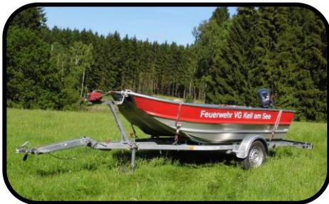
Das RTB 1 bzw. RTB 350 (neue Norm, bezieht sich auf die Länge des Bootes von 3,50m) wird zur Bergung und Rettung an Seen verwendet. Diese Größe des Bootes darf nur auf ruhendem Gewässer eingesetzt werden. Es besteht aus Aluminium, hat einen Außenbordmotor und zwei Kufen am Boden zur Rettung und Bergung auf gefrorenem Gewässer. Zulässig sind vier Personen oder maximal 500 kg Zuladung, bei einem Eigengewicht von 160 kg.
