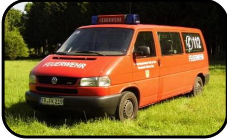
Das MTF basiert auf einem konventionellen VW T4, Radstand lang. Es ist mit Funk und einer RTK 4-SL (Rundumkennleuchte, Lautsprechanlage und Martinshorn) ausgestattet sowie einer feuerwehrtechnischen Beladung. Vorrangig wird das Fahrzeug zum Transport von Personengruppen benutzt. Es findet aber auch Verwendung als Zugfahrzeug für das Rettungsboot der Größe 1 (bzw. 350).
